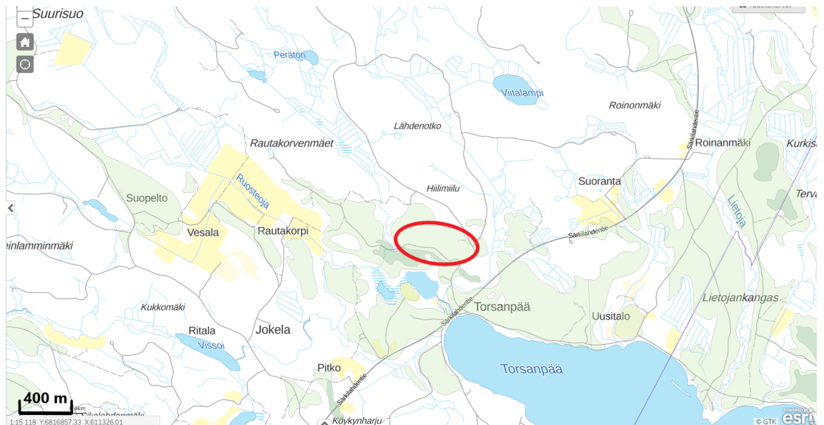
Kuva 2. Yleiskuva harjumuodostumasta (lähde://gtkdata.gtk.fi/maankamara/), ottamisalueen likimääräinen sijainti on merkitty kuvalle punaisella soikiolla. Vaalean vihreällä rasterilla on esitetty Gt:n määrittelemä hiekkavaltaisen esiintymän ulottuvuus ja tumman vihreällä soravaltainen esiintymä.
